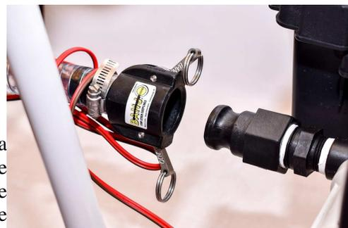
6. Conecte la manguera de desviación de goma roja de 1" al conector de bloqueo de leva del descargador regulador de presión (Figura 11). La manguera de derivación tiene un conector de leva en un extremo. Aleje la manguera de derivación del área de trabajo y asegure la manguera.
